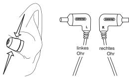
Sicherstellen, dass die Muffe die Ohrhörer-Schallöffnung vollständig abdeckt. Liegt irgendein Teil der Schallöffnung frei, ist die Muffe nicht richtig angebracht.
