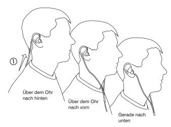
Das Kabel straffen und den Durchhang beseitigen, indem das Kabelröhrchen ① hochgeschoben wird.
