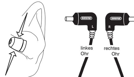
Sicherstellen, dass die Muffe die Ohrhörer-Schallöffnung vollständig abdeckt. Liegt irgendein Teil der Schallöffnung frei, ist die Muffe nicht richtig angebracht.
