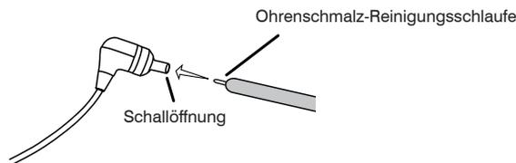
Beim Reinigen nichts mit Gewalt durch die Ohrhörer-Schallöffnung drücken! Sonst würde dadurch der Tonfilter des Ohrhörers beschädigt.
