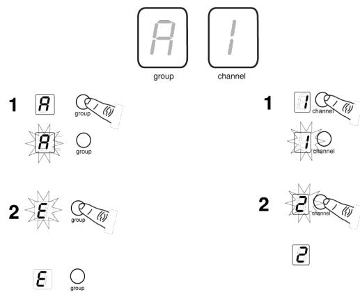
Пр настройке дополнительных систем оставьте включенными первый передатчик и приемник. Для каждого дополнительного приемника вручную установите группу, соответствующую первому приемнику. Примечание. После выбора группы приемник автоматически выполнит сканирование каналов и найдет свободную частоту. Согласуйте частоты передатчика и приемника.
