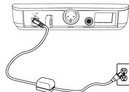
2. Подключите приемник к микшеру или усилителю. Чтобы включить приемник, нажмите кнопку Power.
